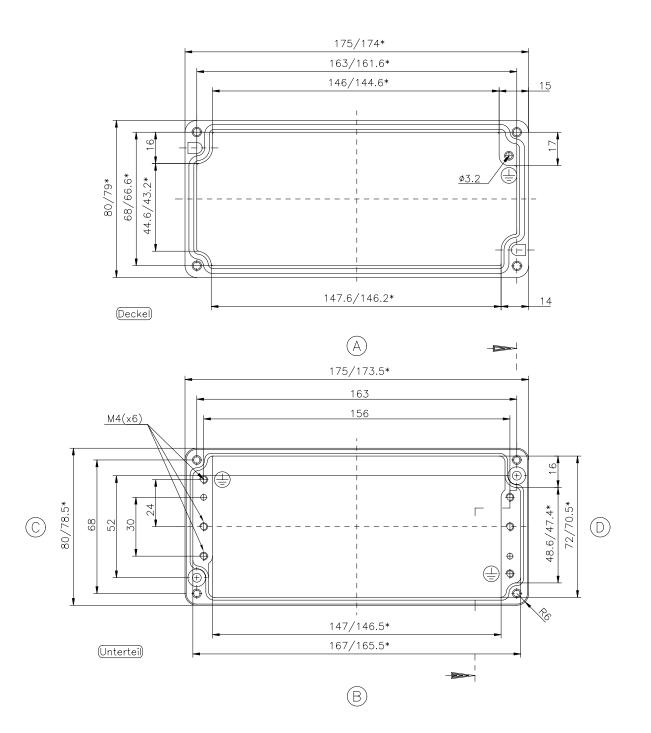
\* = Mass durch Formkonizität nach unten verringert. Freimass — Toleranz nach GTA 13/5 DIN 1688
