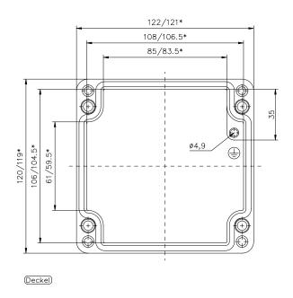
\* = Mass durch Formkonizität nach unten verringert. Freimass - Toleranz nach GTA 13/5 - DIN 1688
