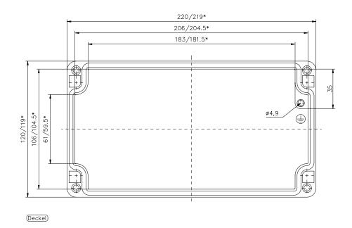
= Mass durch Formkonizität nach unten verringert. Freimass — Toleranz nach GTA 13/5 — DIN 1688
