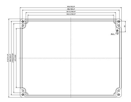
\* = Mass durch Formkonizität nach unten verringert. Freimass - Toleranz nach GTA 14/5 - DIN 1688
