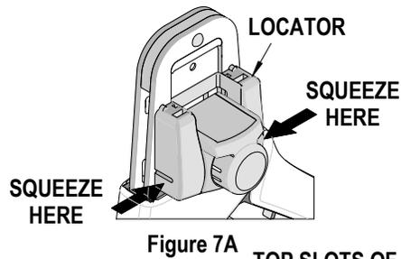
MAKE SURE CENTER OF LOCATOR IS IN THE DOWN POSITION
