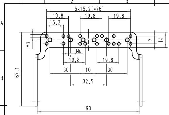
passend für Han 24E, 24ES, 24ESS, 46EE, 64D und 108DD Einsätze zur Kombination mit Han 24B Anbaugehäuse und Han Snap/ fits for Han 24E, 24ES, 24ESS, 46EE, 64D und 108DD inserts for combination with Han 24B housings and Han Snap
