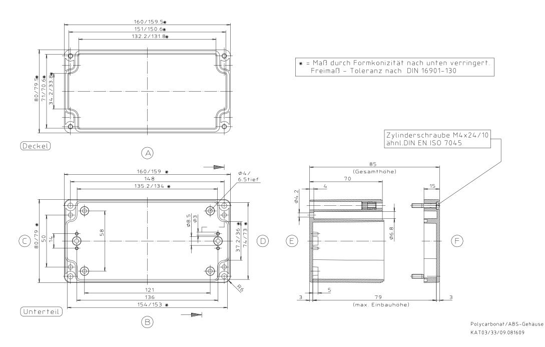
ABS-Gehäuse können durch eine andere Schwindung ca. 0,1–0,25% größer sein als gezeichnete PC-Gehäuse
