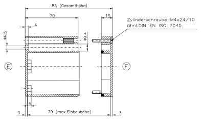
Polycarbonat/ABS-Gehäuse KAT03/33/09.082309 ABS-Gehäuse können durch eine andere Schwindung ca. 0,1-0,25% größer sein als gezeichnete PC-Gehäuse
