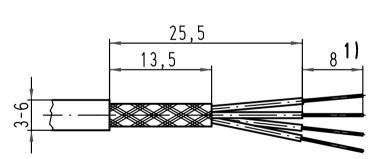
1) Abisolierlänge der Litze mit einem Leiterquerschnitt von 2,5mm² ist 6mm/ stripping length of a 2,5mm² wire gauge is 6mm
