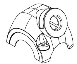
Lieferumfang: Haube mit M4 Schrauben, Scheiben und Dichtungen zur Befestigung am Trägergehäuse / range of delivery: shell with M4 screws, washers and seals to mount on carrier hood
