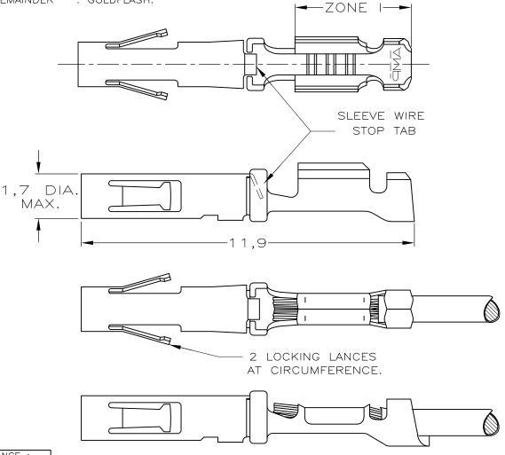
WIRE RANGE 30-26 AWG 0,05-0,14 mm<sup>2</sup> INSULATION RANGE : 1,22 DIA. MAX.
