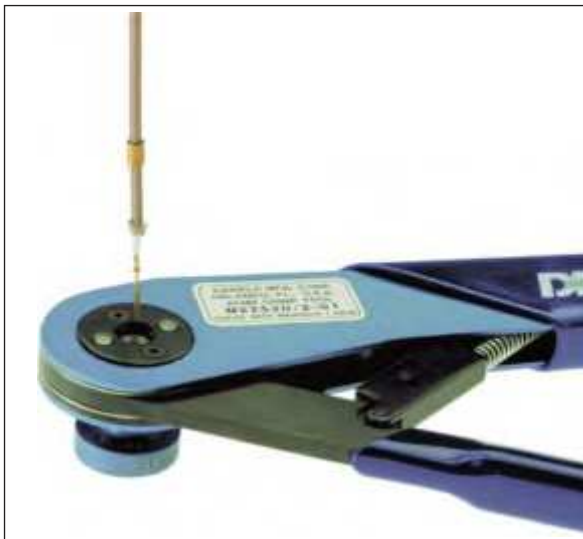
Crimping the inner conductor with hand crimp tool M22520/2-01. Crimpfung des Innenleiters mit der Handcrimpzange M22520/2-01.
