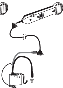
Figure 2b. Localisation d'un câble
