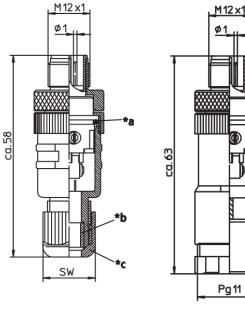
\*a O-Ring \*b gasket \*c cap nut
