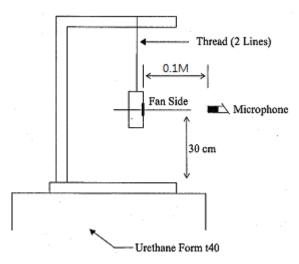
0.1 METER FROM MICROPHONE TO FAN INTAKE
