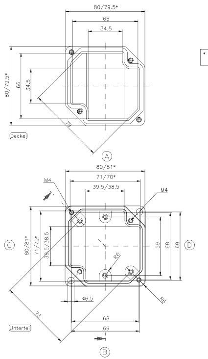
\* = Mass durch Formkonizität nach unten verringert. Freimass — Toleranz nach DIN 16901—140
