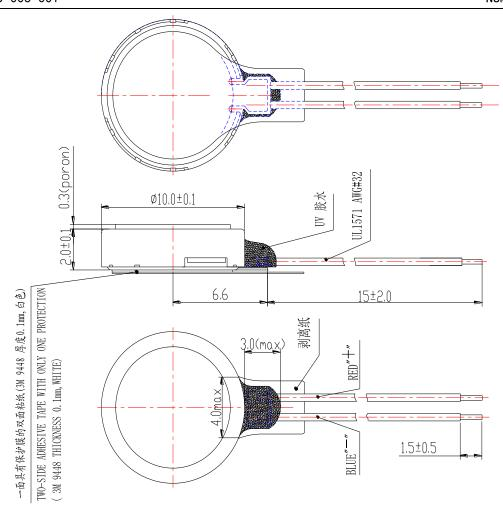
Figure 1 Motor Housing Configuration 图 1 电机外形结构图
