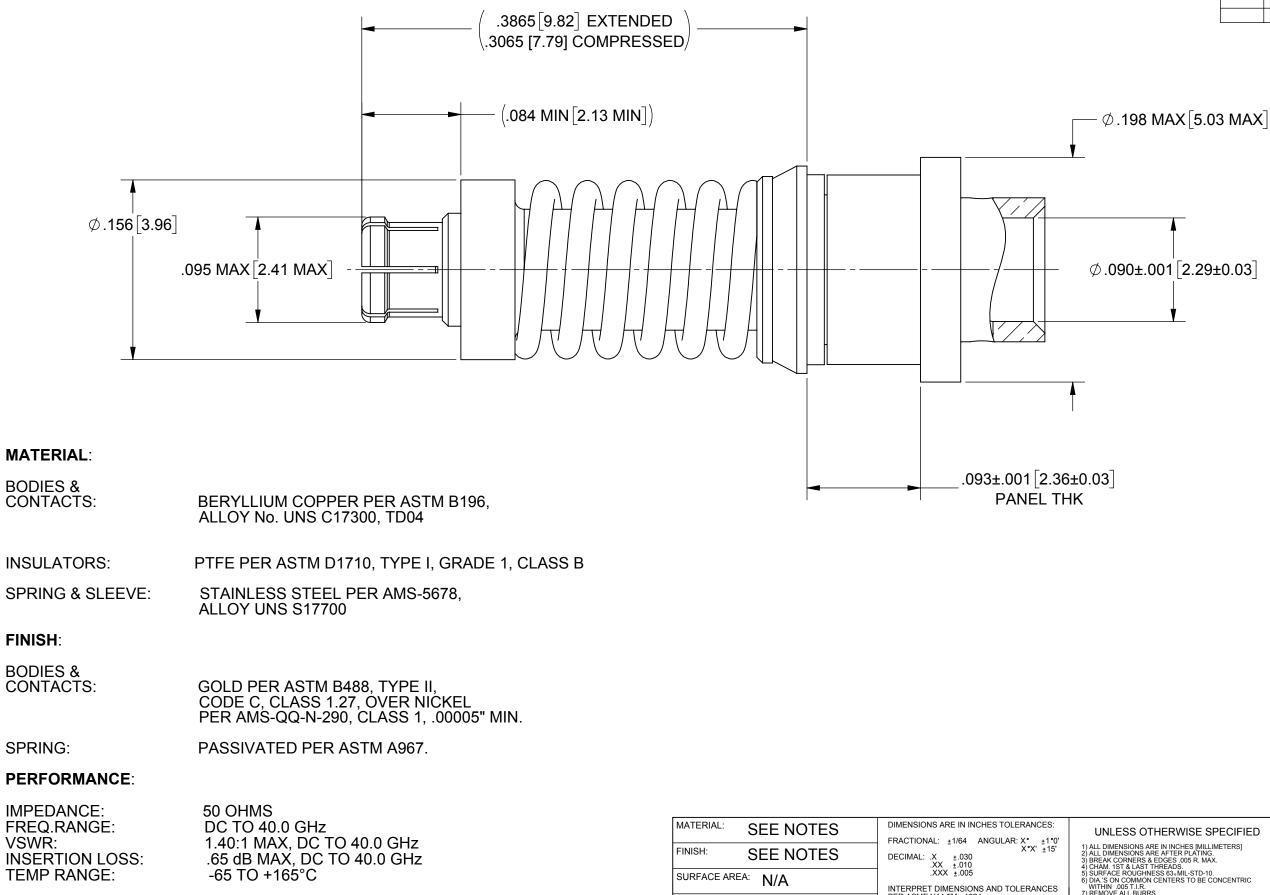
FOR USE IN SF9321-60031 MODULE REMOVAL TOOL P/N 500-32-015
