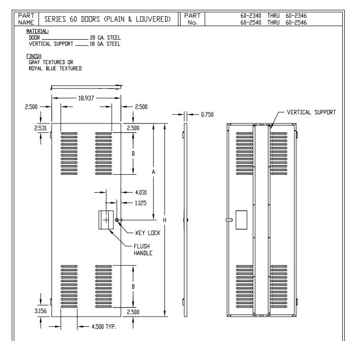
DOORS MAY BE USED FRONT AND/OR REAR FOR SERIES 60 UNITS, REAR DOOR ONLY FOR SERIES 2000 UNITS, ALL INCLINED UNITS USE 42.438 HIGH DOOR FOR REAR. DOORS CAN BE HINGED LEFT ONLY.
