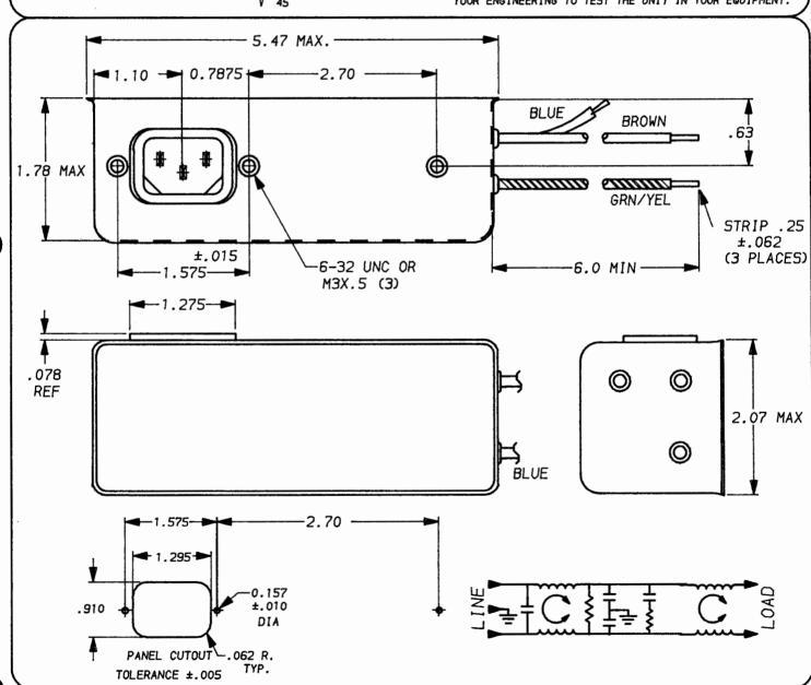
50a - 50a (MINIMUM) INSERTION LOSS FREQUENCY .01.015.02.05.15 .5 2 S 10 20 30 MHz COMMON 28 31 68 72 72 65 55 55 50 45 26 20 dB DIFF. 6 10 43 70 75 75 65 52 55 55 55
