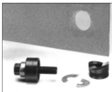
8 Démontez le poinçon en tournant la tige de traction en sens antihoraire tout en tenant le poinçon. Inclinez le moule et faites sortir les manchons fendus.
