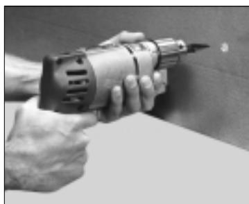
1 Le poinçon utilisé pour un conduit de 1/2 po nécessite un orifice d'amorce de 3/8 po ou plus. Utilisez les mèches d'amorce conique Kwik Stepper de Greenlee.
