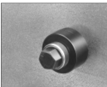
6 Pour les orifices destinés aux conduit de 3/4 po à 2 po, utilisez des tiges de traction de 3/4 po 304AVBB. Placez le moule de la grandeur requise sur la tige de traction. Insérez la tige de traction dans l'orifice d'amorce de 3/4 po ou plus. Vissez un poinçon de la même grosseur sur la tige de traction et orientez la lèvre tranchante vers le matériaux à percer.
