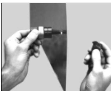
2 Placez le moule pour le conduit de 1/2 po sur la tige de traction de 3/8 po. Insérez la tige de traction dans l'orifice d'amorce.
