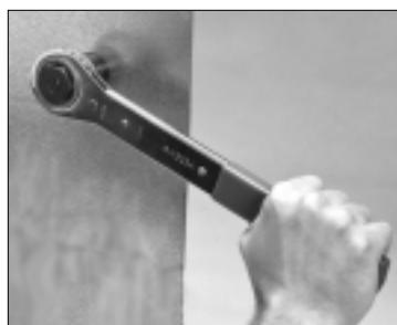
4 Tournez la tige de traction en sens horaire à l'aide d'une clé 34941 jusqu'à ce que le matériau soit perforé.
