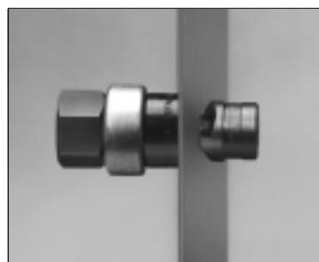
3 Vissez le poinçon sur la tige de traction en orientant le lèvre tranchante vers le matériau à percer.
