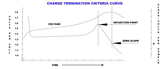
**BULK CHARGE CYCLE CURVE**
