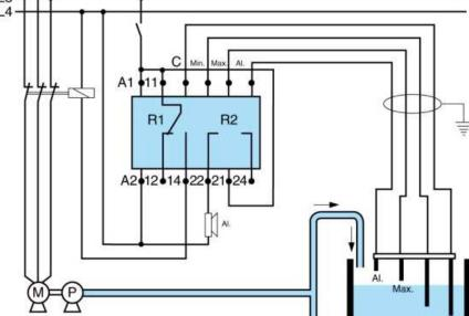
Note: Dans le cas où le réservoir est conducteur (métal), il peut être utilisé comme électrode de référence (C). Une LED verte visualise l'alimentation. Une LED jaune visualise l'état du relais de sortie. Une LED rouge visualise, l'état du relais d'alarme.
