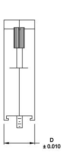
MATERIAL: DIE-CAST ZINC ALLOY PLATING: BLACK OVER COPPER JACKSCREWS: STEEL - BLACK STEEL - BLACK COMPRESSION INSERT: OPERATING TEMP: -30°C TO +90°C
