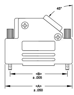
PLASTIC: ABS POLYLAC - BLACK - UL 94-HB JACKSCREWS: STEEL - BLACK **HOOD SCREWS: STEEL - BLACK COMPRESSION INSERTS: ABS UL 94-HB NUTS: STEEL - BLACK**
