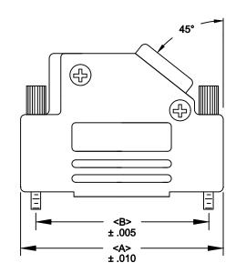
MATERIAL: DIE CAST ZINC ALLOY PLATING: BLACK OVER COPPER JACKSCREWS: STEEL - BLACK **HOOD SCREWS: STEEL - BLACK COMPRESSION INSERTS: ABS UL 94-HB** OPERATING TEMP: -30°C TO + 90 °C
