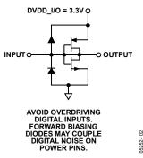
Figure 29. CMOS Digital Inputs
