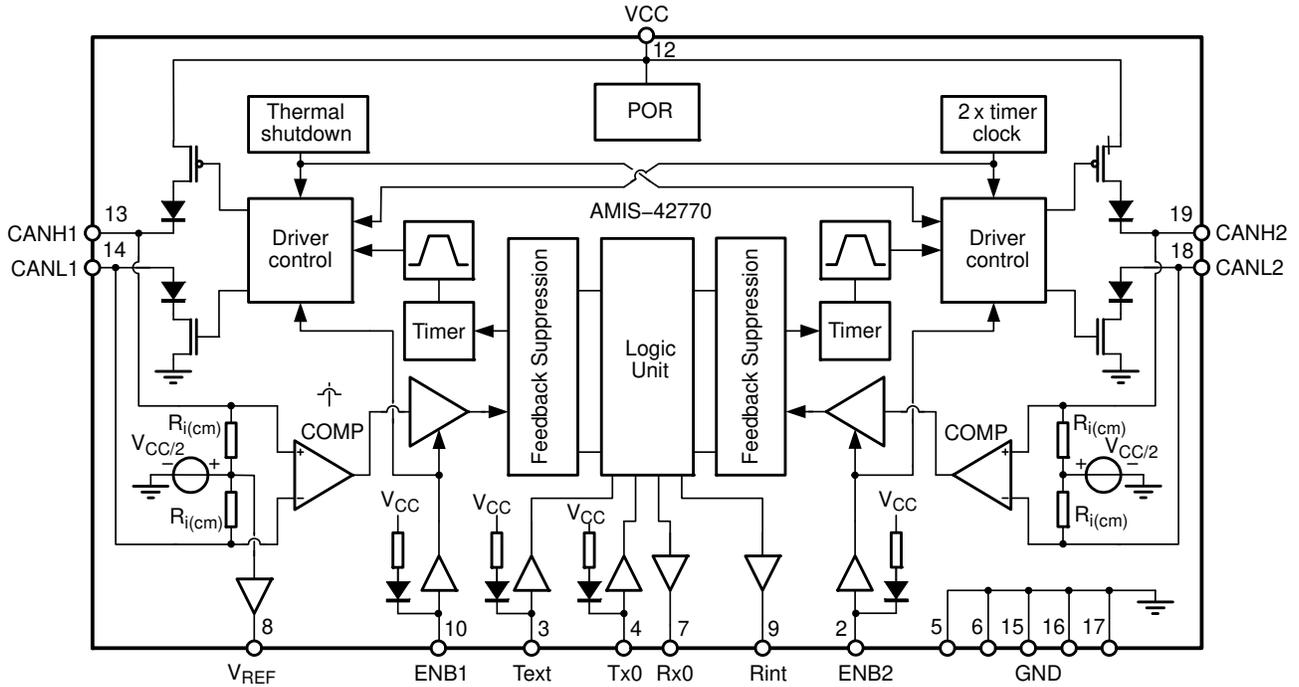
**Figure 1. Block Diagram**
