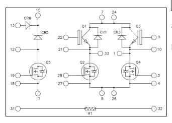
Top switches : Trench + Field Stop IGBT3 Bottom switches : CoolMOS<sup>™</sup> Boost chopper : CoolMOS<sup>™</sup>
