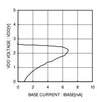
Fig. 9 REG Current Capacity
