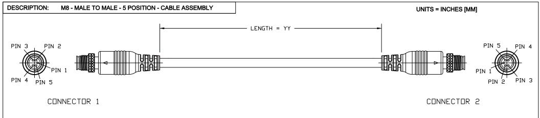
WIRE: 26AWG, 2 1/2 TWISTED PAIRS, UL20276, FOIL/BRAID/DRAIN SHIELD, COLOR BLACK, 30V
