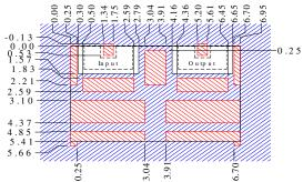
D im e n sio n s a re in m m . To le ra n c e = +/-0.13
