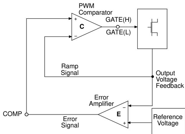
**Figure 9. V<sup>2</sup> Control Diagram**
