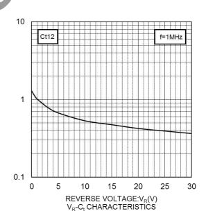
CAPACITANCE BETWEEN TERMINALS:C<sub>f</sub>(pF)
