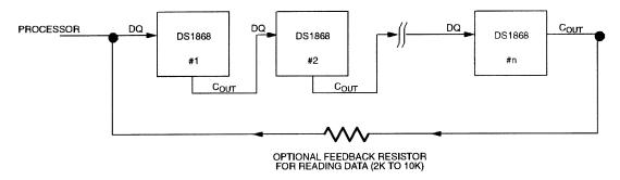
The  $C_{OUT}$  output of the DS1868 can be used to drive the DQ input of another DS1868. When connecting multiple devices, the total number of bits transmitted is always 17 times the number of DS1868s in the daisy chain.
