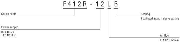
L : 0.11 m³/min M : 0.15 m³/min
