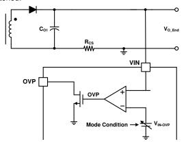
Figure 40. V<sub>IN</sub> Over-Voltage-Protection Block
