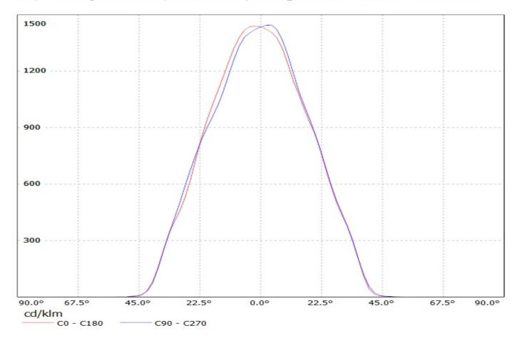
Luminaire: LEDil Oy FCN13928\_BARBARA-WW-PF-VERO10\_(VERO10) Efficiency=89% Lamps: 1 x Bridgelux VERO10 (BXRC-35E1000B) 720lm @ 250mA CCT=3600K P=6.4W I=250mA
