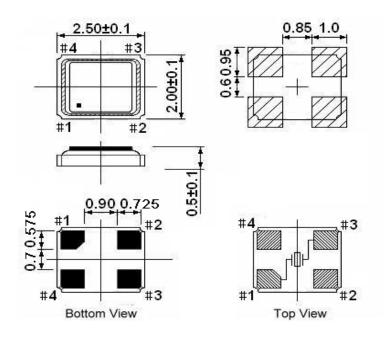
\*\* Recommended - Pin 1 & 3 : CRYSTAL Pin 2 & 4 : GND
