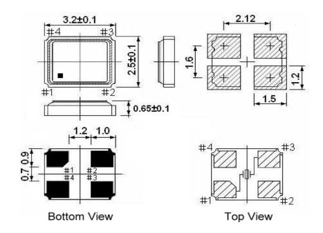
\*\* Recommended - Pin 1 & 3 : CRYSTAL Pin 2 & 4 : GND
