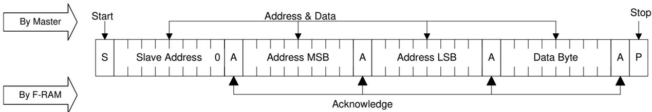
**Figure 18. Multi-Byte Write**
