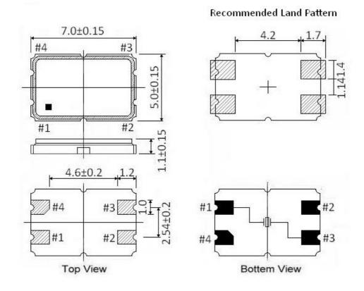
\*\* Recommended - Pin 1 & 3 : CRYSTAL Pin 2 & 4 : GND
