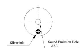
Tolerance:± 0.5 Unit:mm
