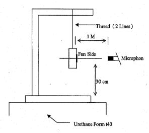
1 METER FROM MICROPHONE TO FAN INTAKE
