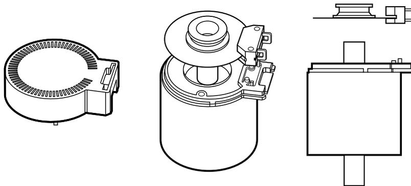
**ALIGN ENCODER MODULE AND CODEWHEEL AS SHOWN. BE CAREFUL NOT TO DAMAGE THE ENCODER INTERNAL COMPONENTS WITH THE CODEWHEEL.**
