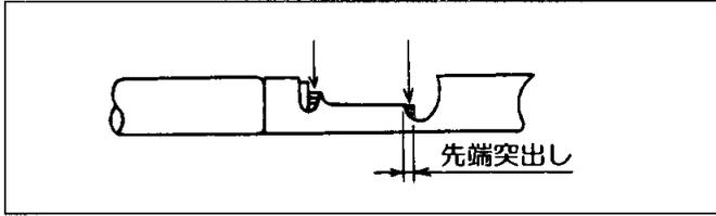
適正なストリップ長さ：圧着した際、ワイヤーバレル先端から導線が突出しており、また被覆がインシュレーションバレルより引っ込んでいたりワイヤーバレル内に入り込んでいない状態であること。
