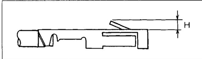
圧着した端子のランスの高さが所定の寸法内にあるか確認してください。
