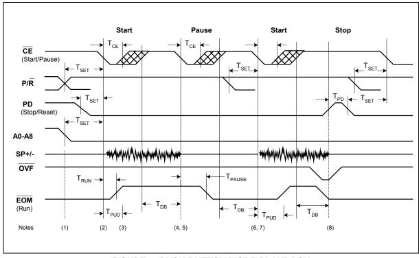
FIGURE 4: PUSH-BUTTON MODE PLAYBACK
