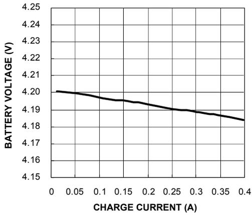
FIGURE 1. CHARGER OUTPUT VOLTAGE vs CHARGE CURRENT
