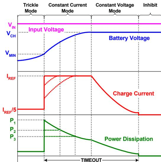
FIGURE 22. TYPICAL CHARGE CURVES USING A CONSTANT-VOLTAGE INPUT
