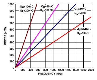
FIGURE 9. POWER DISSIPATION vs FREQUENCY
