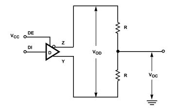
FIGURE 1. DRIVER  $V_{\mbox{\scriptsize OD}}$  and  $V_{\mbox{\scriptsize OC}}$
